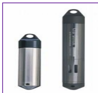
Рис.3.5 – Внешний вид MiniDiver и снятие с него показаний УГВ через разъем USB в наблюдательном пьезометре №2
