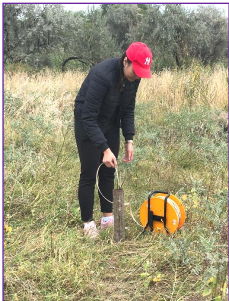
Рис.2.5– Замер УГВ в скважине с использованием электрического уровнемера (производство Канада) со звуковым и световыми сигналами - индикаторами при контакте с водой.
