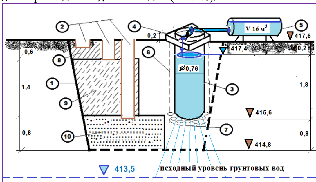
Рис. 1.6 - Схема состава и параметров оборудования для проведения опытных исследований скорости инфильтрации, удельной водоотдачи поверхностей инфильтрации и изучения процессов кольматации
