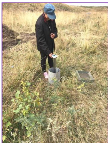
Рис. 6.5 - Фото автора: Выполнение мониторинга формирования гидрохимического режима грунтовых вод в наблюдательном пьезометре, оборудованном в зоне влияния и во время работы мини бассейна №1 на Аксуском репрезентативном участке с использованием цифрового экспресс-прибора – кондуктометра
