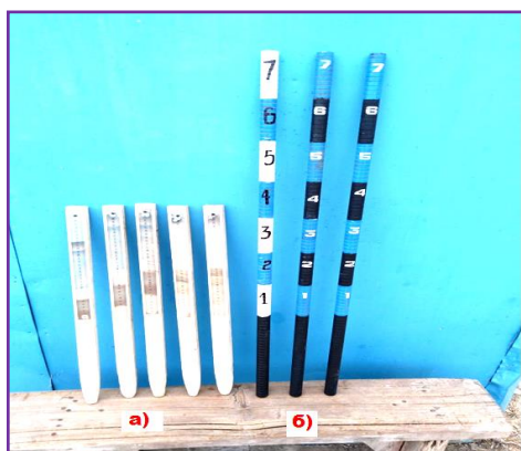
Рис.2.3 – Фото автора: откалиброванные водомерные рейки для выполнения полевых гидрологических и балансовых исследований в створах гидрометрических постов
