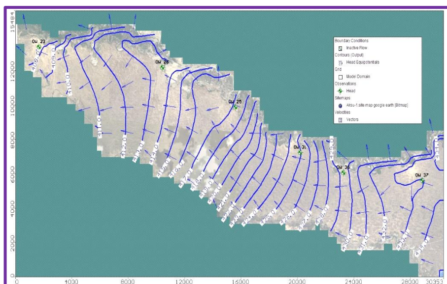
Рис.4.7 - Карта гидроизогипс и векторов направления потока подземных вод по состоянию на январь 2018, используемая в качестве начальных условий для расчета на модели.
