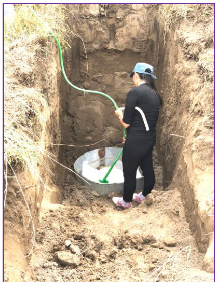
Рис.5.4 - Фото автора : проведение налива в покровные отложения - слабопроницаемые суглинки, методом Нестерова Н.С. в подготовленном шурфе №1 на Аксуском репрезентативном участке
