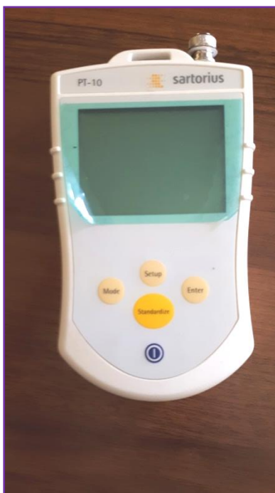
Рис. 5.5 – Фото одного из комплекта откалиброванных портативных базовых приборов pH-метров от компании Sartorius (Германия) для измерений в полевых условиях величины водородного показателя воды
