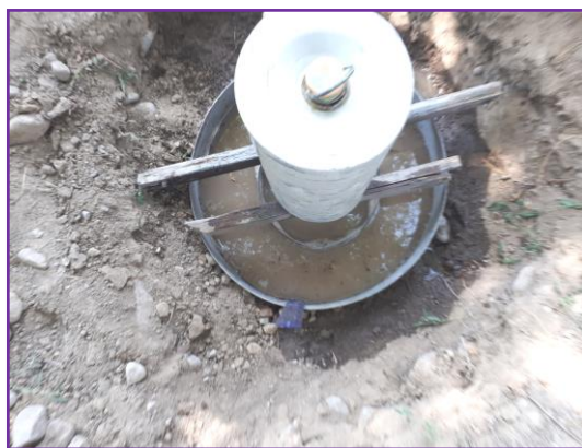
Рис.5.4 - Фото автора : проведение налива в покровные отложения - слабопроницаемые суглинки, методом Нестерова Н.С. в подготовленном шурфе №1 на Аксуском репрезентативном участке
